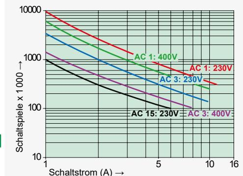
Maximale Kontaktbelastung bei AC 1 mit 230 V:
