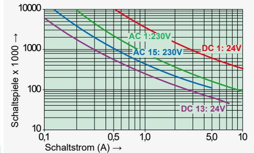
Max. Schaltvermögen (DIN EN 60947-5-1, Tab. C2)
