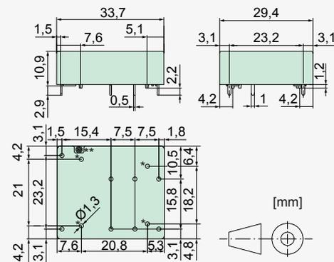
\* bei SMD-Bestückung unter dem Relais nicht bohren
