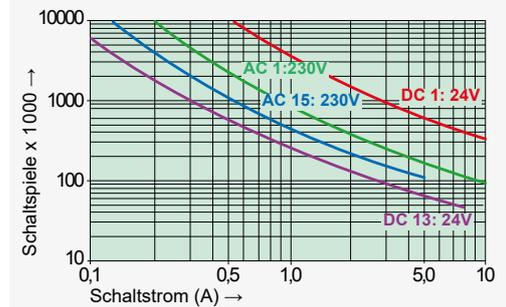
Max. Schaltvermögen (DIN EN 60947-5-1, Tab. C2):
