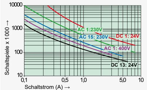
Max. Schaltvermögen (DIN EN 60947-5-1, Tab. C2)
