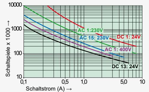
Max. Schaltvermögen (DIN EN 60947-5-1, Tab. C2)
