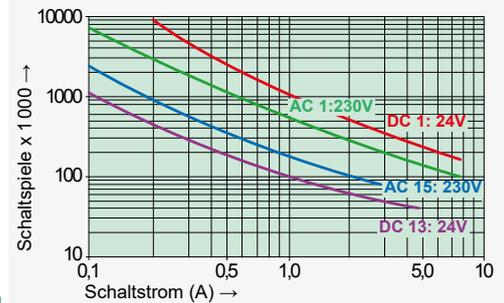
Max. Schaltvermögen (DIN EN 60947-5-1, Tab. C2)
