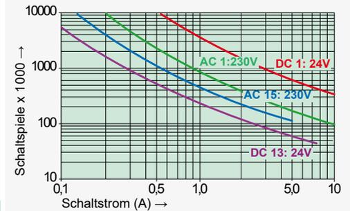
Max. Schaltvermögen (DIN EN 60947-5-1, Tab. C2)
