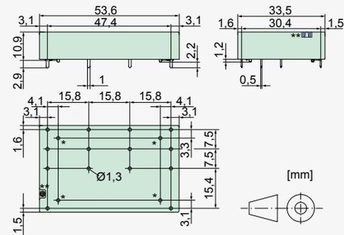
\* bei SMD-Bestückung unter dem Relais nicht bohren
