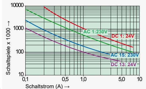
Max. Schaltvermögen (DIN EN 60947-5-1, Tab. C2)
