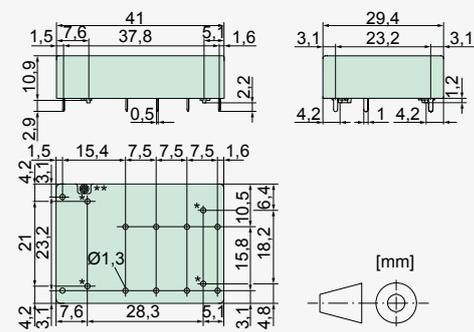
\* bei SMD-Bestückung unter dem Relais nicht bohren
