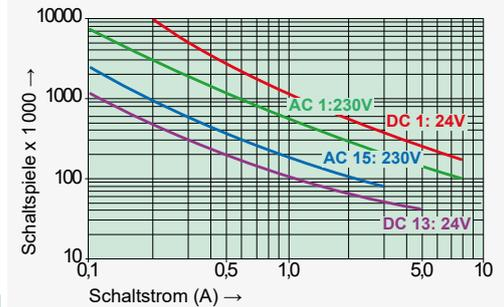
Max. Schaltvermögen (DIN EN 60947-5-1, Tab. C2)
