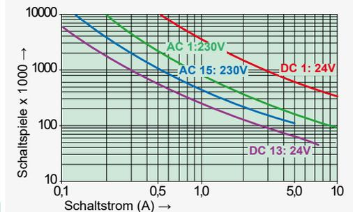
Max. Schaltvermögen (DIN EN60947-5-1, Tab.C2)
