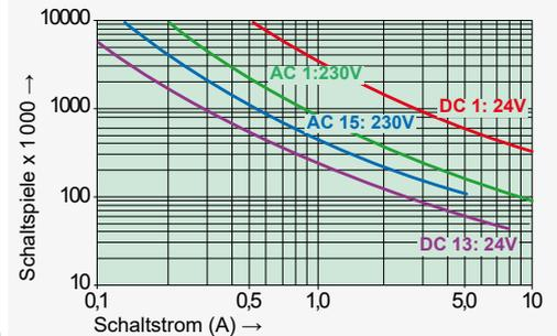
Max. Schaltvermögen (DIN EN 60947-5-1, Tab. C2):
